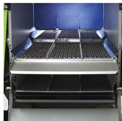
Плоскорешетный соломотряс и очистительное сито
