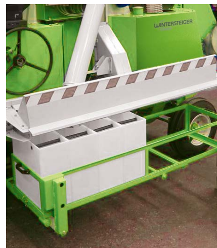
Устройство затаривания в контейнеры на салазках с боковой стороны
